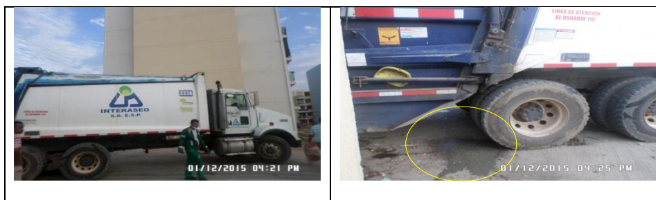
Vehículo # 2238 cubriendo la ruta 207 en el barrio Nando Marín, Presentando fuga de lixiviado.
