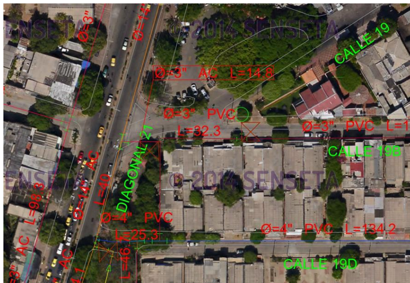
Ubicación optimización prestación servicio de acueducto Calle 19 con Carrera 18 C
